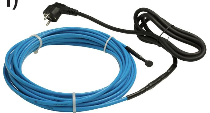
DEVipeheat™ 10 (DHP) ist ein selbstbegrenzendes Heizband, dessen temperaturabhängiges Widerstandselement die Heizleistung reguliert und begrenzt. Dieser Prozess vollzieht sich – abhängig von der Umgebungstemperatur – an jeder Stelle des Heizbandes.
