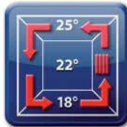
Bei herkömmlichen Heizkörpern sind die Temperaturen am Fußboden vergleichsweise niedrig. Die abgestrahlte Wärme sammelt sich unter der Decke, bis sie abgekühlt ist. Somit wird die Behaglichkeit als gering und die Temperatur als zu niedrig empfunden.
