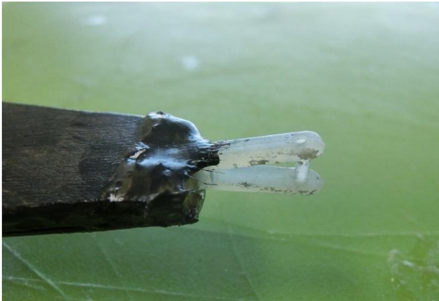
29. Um den Gabelkopf am Rumpf stabil zu befestigen, kann ein 6 mm Aluröhrchen durch den Rumpf geschoben werden, die enden mit einer Zange platt gedrückt und leicht dem Winkel angebogen werden. Diese Enden für den Gabelkopf durchbohren.
