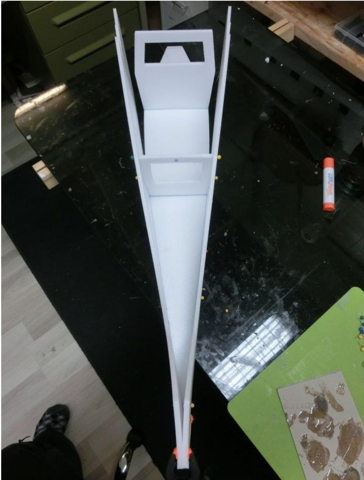
**6. Rumpfboden ankleben. Auch hier auf einen geraden Verlauf des Rumpfes achten und keinen Verzug einbringen. Die Verzäpfung am Rumpf hilft den Rumpf Verzugsfrei zusammenzusetzen. Die Seitenleitwerksteile auch zusammenkleben.**
