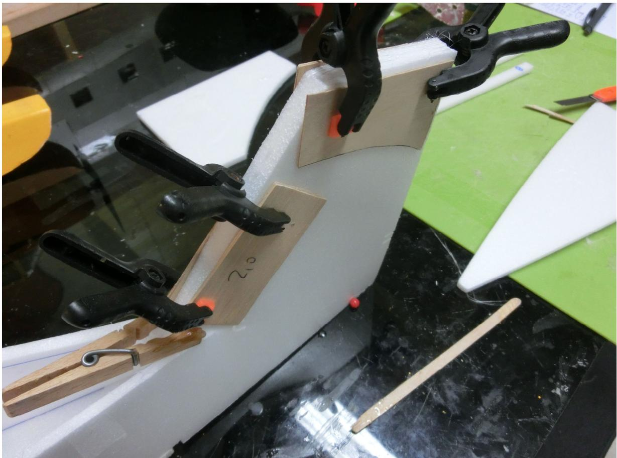
**7. Spant 3 an den Seitenteilen kleben. Spantunterseite dem Formverlauf nach anschleifen und dann auch den Boden ankleben.**
