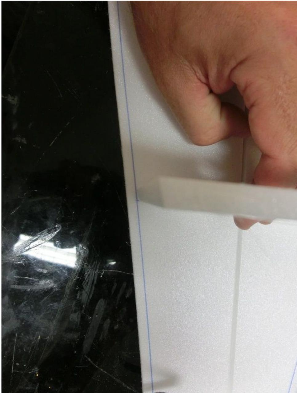
**5. Spant 4 + 5 erst an einen der Rumpfseitenteile ankleben, dann zweiter Seitenteil ankleben.**
