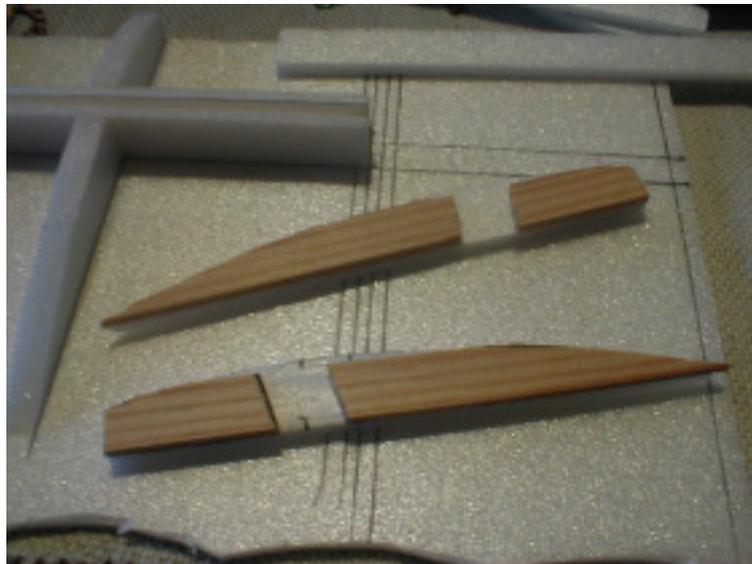
**50.**10X2 Kiefernleiste ( 746 mm Gesamtlänge ) im Bereich der **T6/T14** Rippen trennen und mit Epoxy Hard einkleben.
