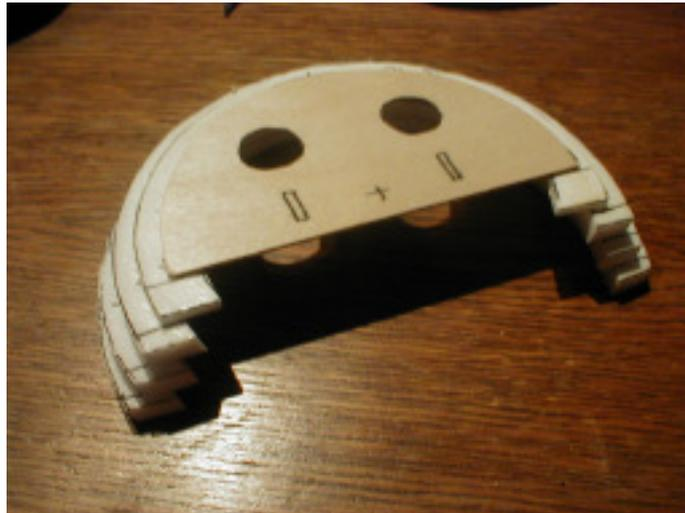
24. Der so entstandene Motorhaubenring so auf dem Rumpf verkleben, dass die Bauteile **24a** und **23** bündig aufeinander sitzen.
