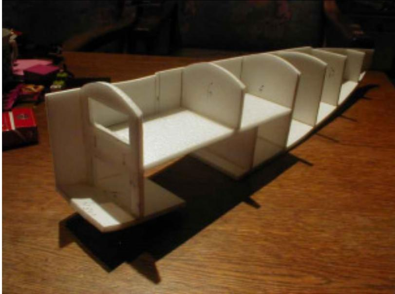
6. Im Heckbereich hinter Spant **13** eine 50 mm lange 10X2 Kiefernleiste auf die Bodenplatte kleben. Diese soll die Belastung des Hecksporns abfangen.
