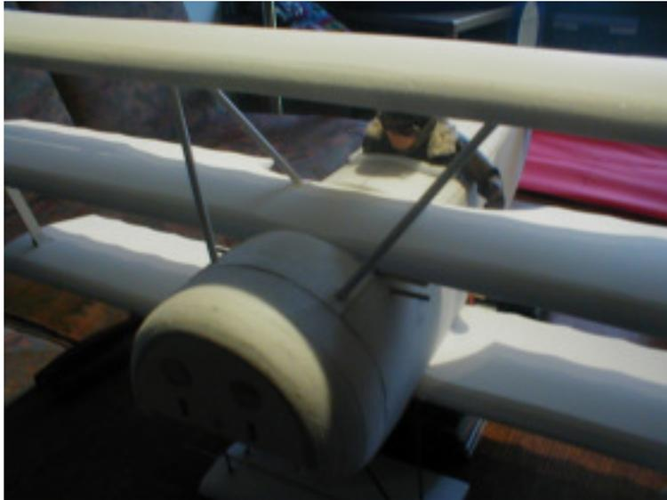
**88.** Vordere Abstützung liegt am Rumpf auf und kann mit eingestecktem Rundholz an der Spitze in den Rumpf eingesteckt und so fixiert werden.
