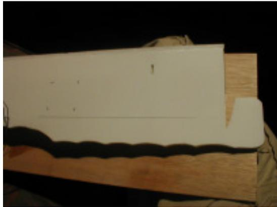
**74.**Die Position der 3 mm Rundhölzer zur Befestigung der Tragflächen laut Anrisse auf den Rumpfseitenteilen durchstoßen und Rundhölzer mit 12-15 mm Überstand einkleben.
