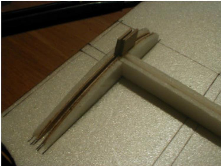
**40.**Konstruktion nun verschleifen, dass alle Bauteile im Beplankungsbereich bündig abschließen.
