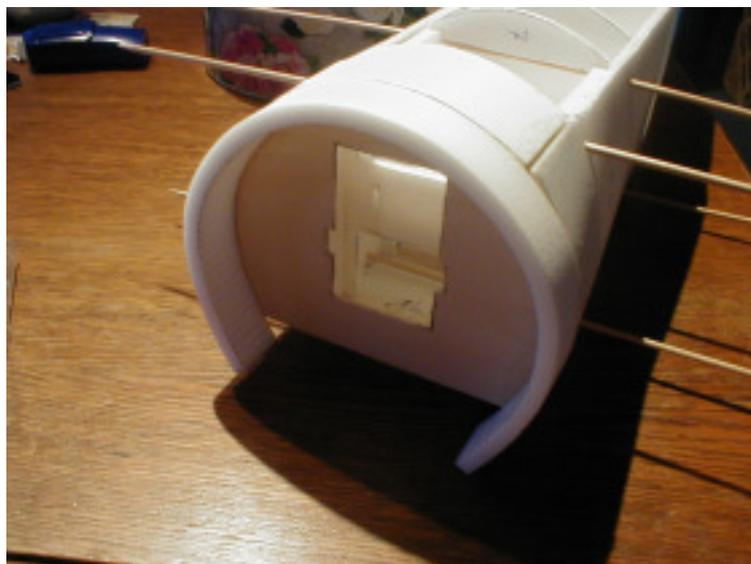
**23.**Jetzt wird die Motorhaubenrundung hergestellt. Dazu die Ringe **24 a-d** auf einer Unterlage legen. Zuerst Ring **24b** auf **24a** legen. Ringe laut Klebemarkierungen auf den Ringen zusammenkleben. Danach **c** und **d** auflegen und verkleben.
