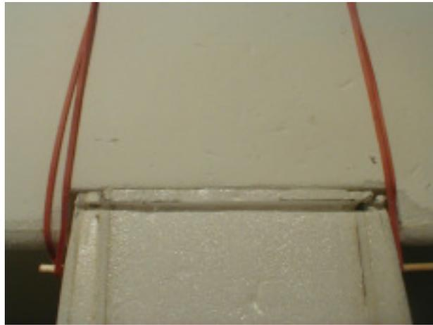
**107.** Beim Verkleben des Fahrwerksdrahtes am Rumpf auch auf einen geraden Sitz des Fahrwerksbodens achten:
