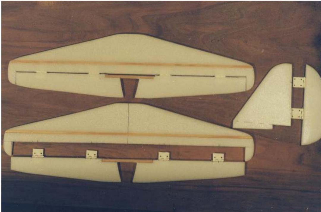
27. Mittels Scharniere Höhenruder wieder am Leitwerk verbinden.
