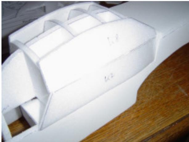
14. Hinterer Dachbereich **K9** mit Materialüberstand ( nach oben hin ) verkleben.
