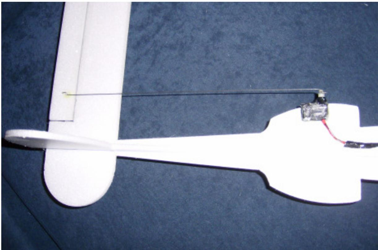
23. Die RC Komponenten können beispielhaft mit doppelseitigem Klebeband für Kabel, Empfänger etc.laut Bild angebracht werden.
