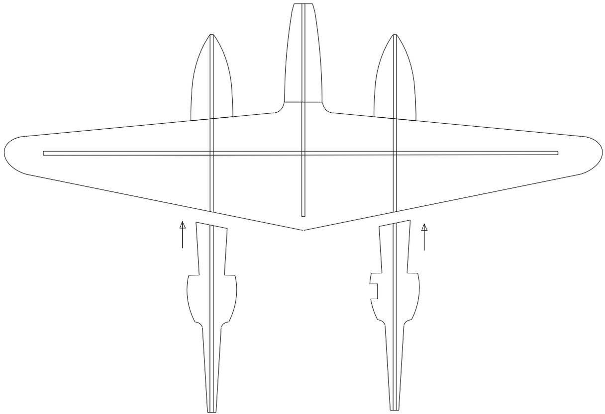
6. Höhenleitwerk an die beiden Leitwerke ankleben.
