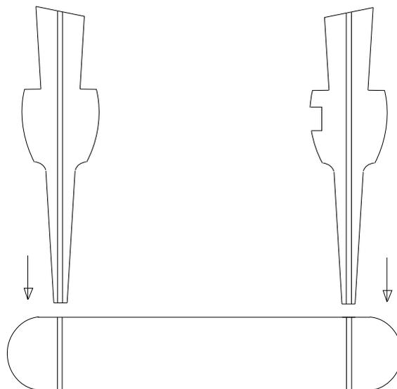
7. Die Seitenansichten der unteren Seite bitte zuerst aufkleben. Die Bauteile sind größer und stabilisieren das Modell besser.
