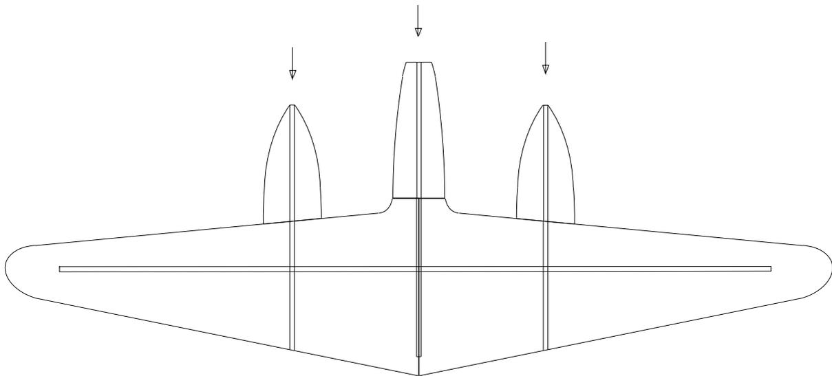
4. Zum einsetzen des Kohlefaserrohres laut Anriss in der Tragfläche den Bereich freischneiden und CFK-Rohr ( 800 mm ) einkleben.
