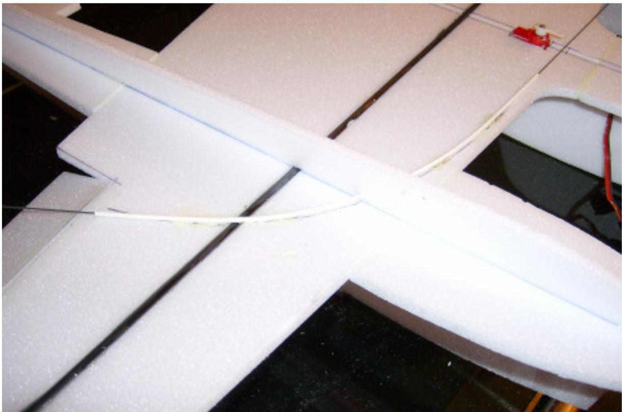
17. Den Bowdenzugdraht für das anschließen am Servo abkröpfen und beide Drähte mit Überlänge vom Servo her in die Bowdenzugröhrchen einschieben. Servo anschließen.
