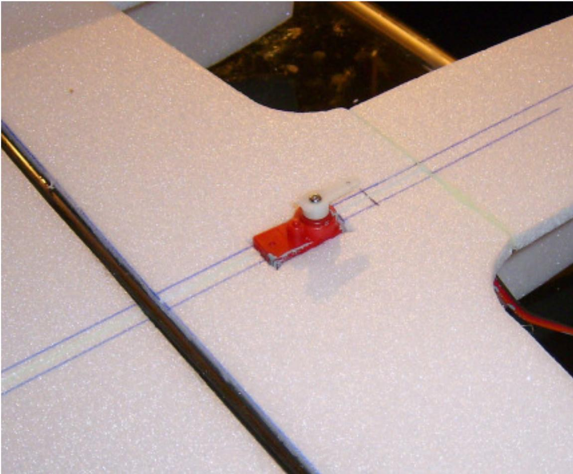
13. Querruder aus der Fläche herausschneiden und an den 3 Schnittflächen 2 mm abschleifen. So entsteht genug Abstand / Freilauf für die Funktion beim nachfolgendem ankleben der Ruder. Tragfläche wie folgt noch beschleifen:
