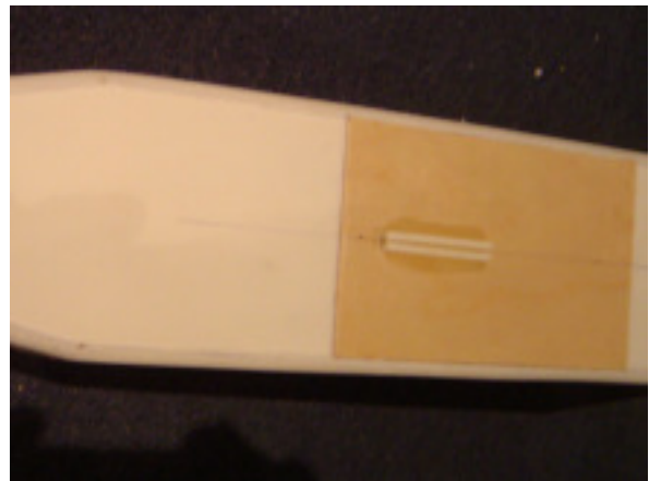
Sperrholzplatte zur Kraftaufnahme
