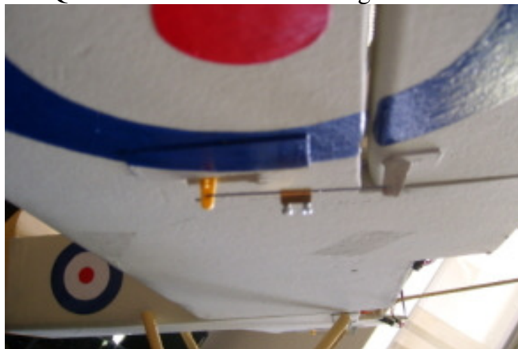
Querruderservos am Ruder angeschlossen
