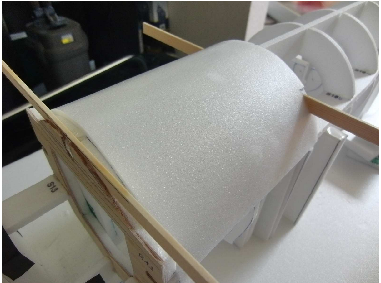
15. 6X6 Depronstreifen R8 als Auflage an die Sperrholzspanen kleben.
