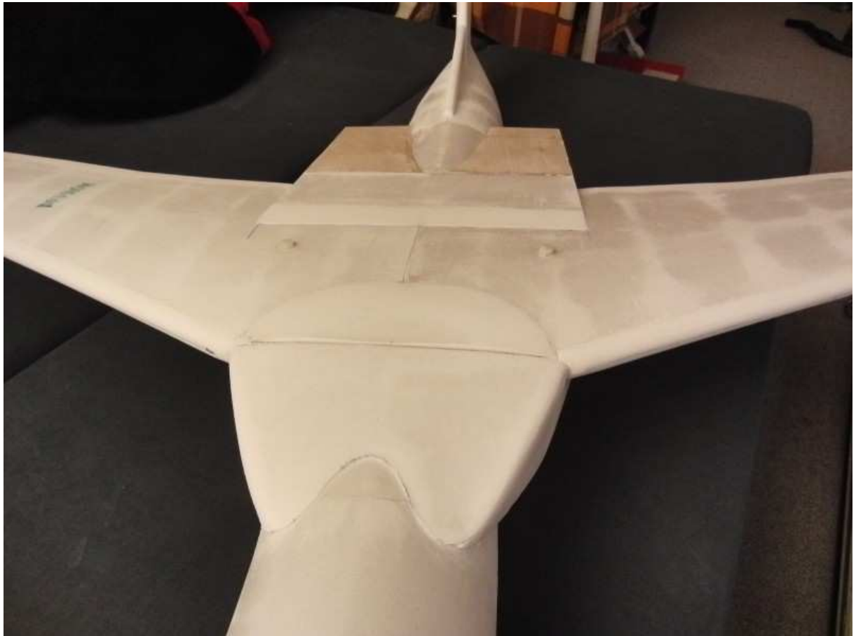
56. Triebwerksgondel Mantelfläche R29 anbiegen ( dünne Flasche bietet sich an als Form während des Erwärmens ).
