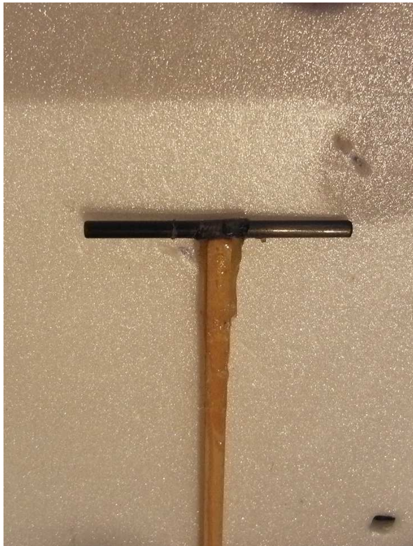
28. Den 3 mm CFK Rundstab anlaminieren für einen besseren Halt.
