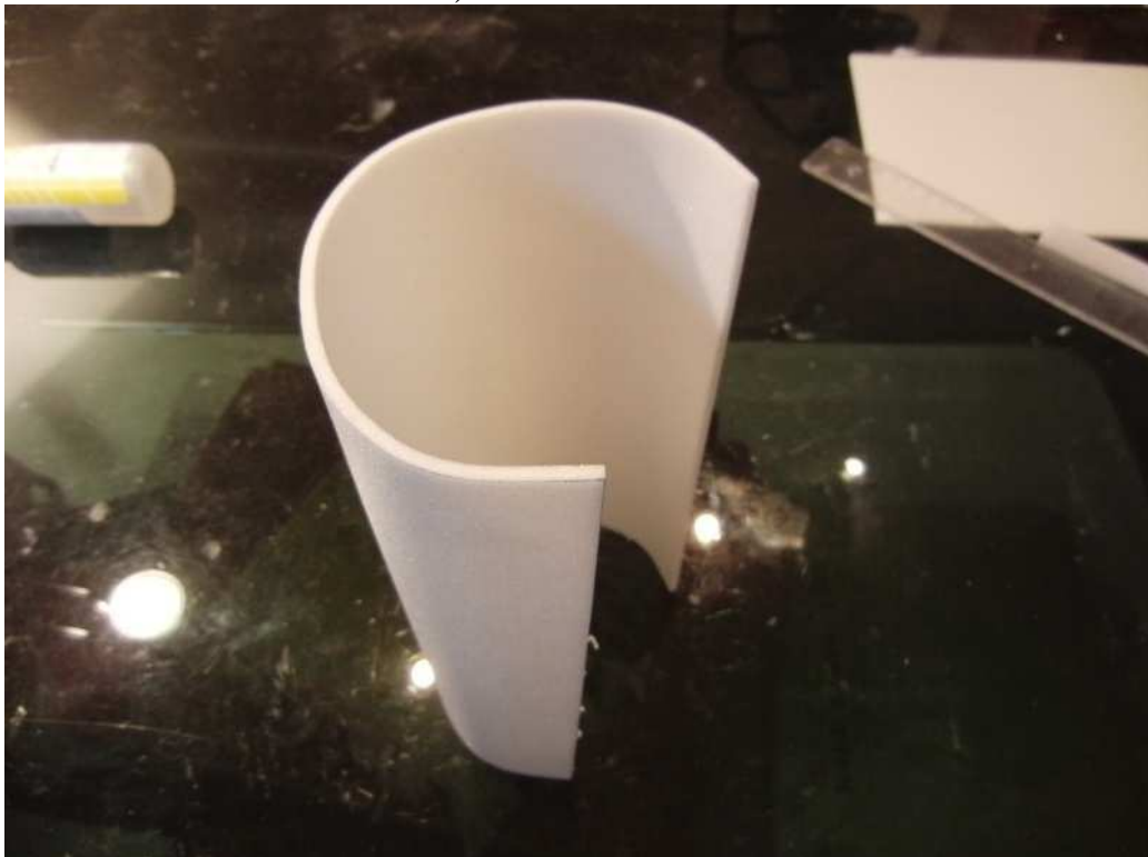
56. Triebwerksgondel Mantelfläche R29 anbiegen ( dünne Flasche bietet sich an als Form während des Erwärmens ).
