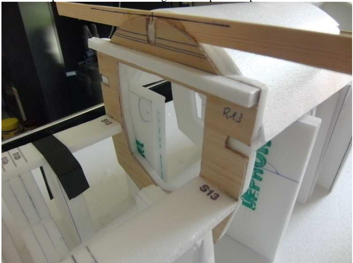
15. 6X6 Depronstreifen R8 als Auflage an die Sperrholzspanen kleben.
