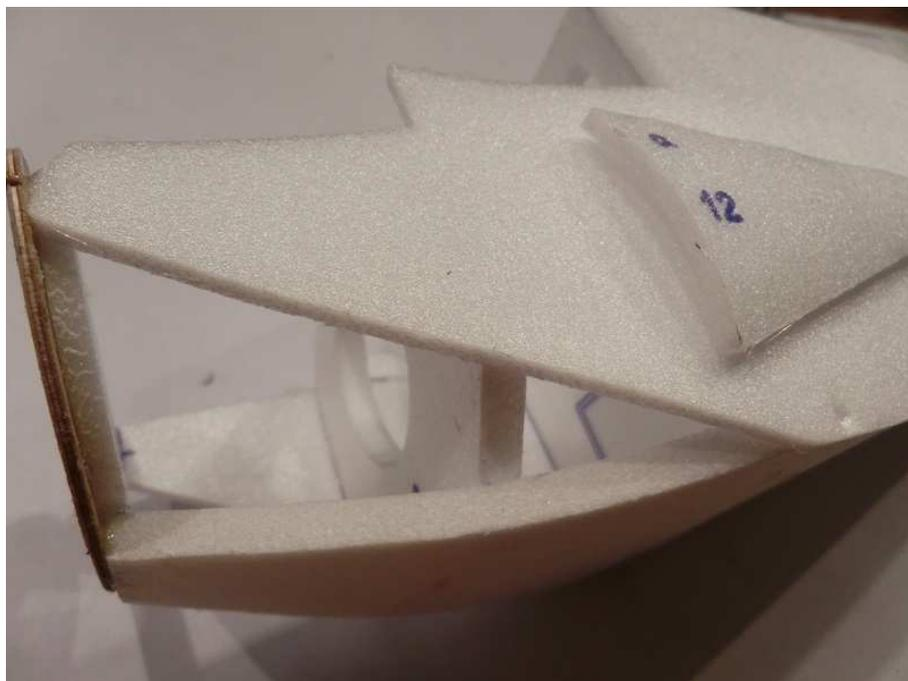
14. Bevor das Höhenruder aus dem Leitwerk getrennt werden kann, die beiden Ruder miteinander verbinden. Dazu dient ein 2 mm Rundholz oder wie hier ein 2 mm CFK Stab. Wie auf dem Foto zu sehen können unterschiedliche Scharniertypen eingesetzt werden.
