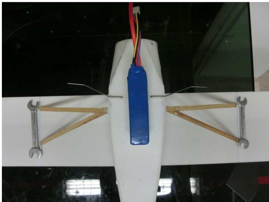
**31. Nun Bowdenzug Außenrohre auf die „Innenrohre“ stecken und die „Außenrohre“ nun am Rumpf und an der Tragfläche ankleben. Auch hier ein Streifen GFK Matte nach der Verklebung darüberlegen. Nun ist die Tragfläche stabilisiert und ohne Verzug ausgerichtet. Zur Demontage das Kiefernholz etwas zusammendrücken, und die Verstrebung kann entnommen werden. Falls das zu stramm geht, die Innenröhrchen etwas kürzen.**
