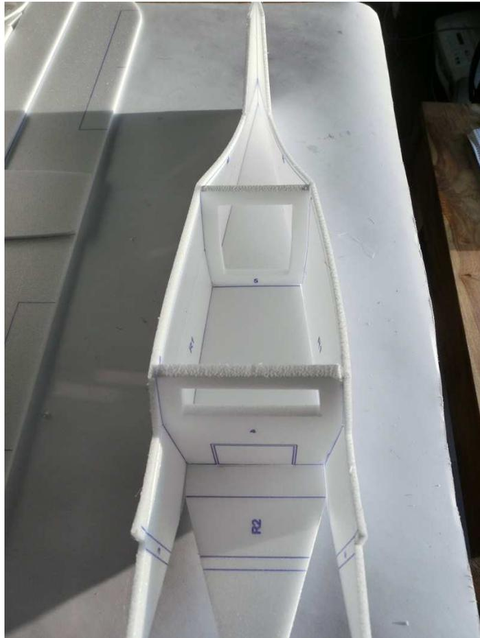
**7. Spant 3 an den Seitenteilen kleben. Spantunterseite dem Formverlauf nach anschleifen und dann auch den Boden ankleben.**
