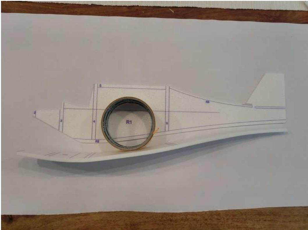
2. Für den Rumpfknick mit dem Cuttermesser vorsichtig einen „V“ – Schnitt auf den Rumpfrippenseiten ! Wichtig ! durchführen. Wichtig: nur max.  $\frac{1}{2}$  Materialstärke einschneiden. Den Schnitt entlang der Linie bis zum Heck ausführen.
