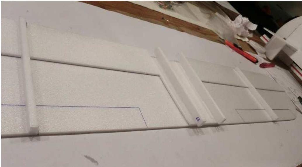
**29. Nun den Rumpf Überkopf auf die Tragfläche legen. Damit der „V“ Knick gut ausgebildet wird, die Tragfläche etwas beschweren Die Tragflächenverstrebungen und an die Markierungen ausrichten.**
