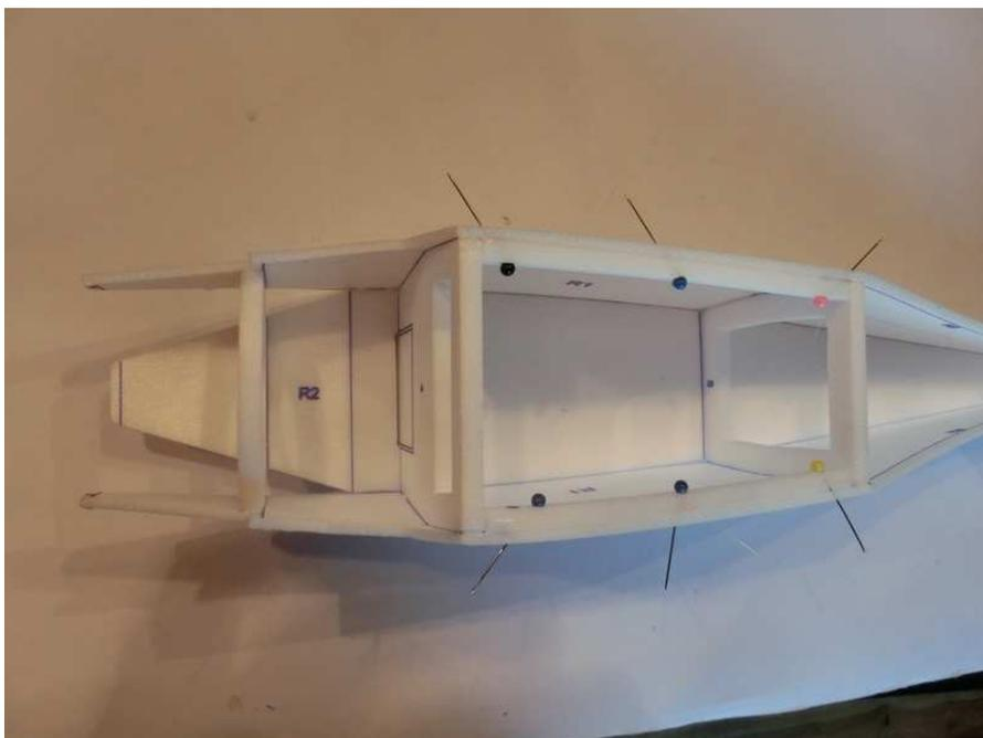
**9. Sperrholzspant 1 auf Depronspant 2 kleben. Darauf achten, dass der Sperrholzspant 3 mm gleichmäßig übersteht.**
