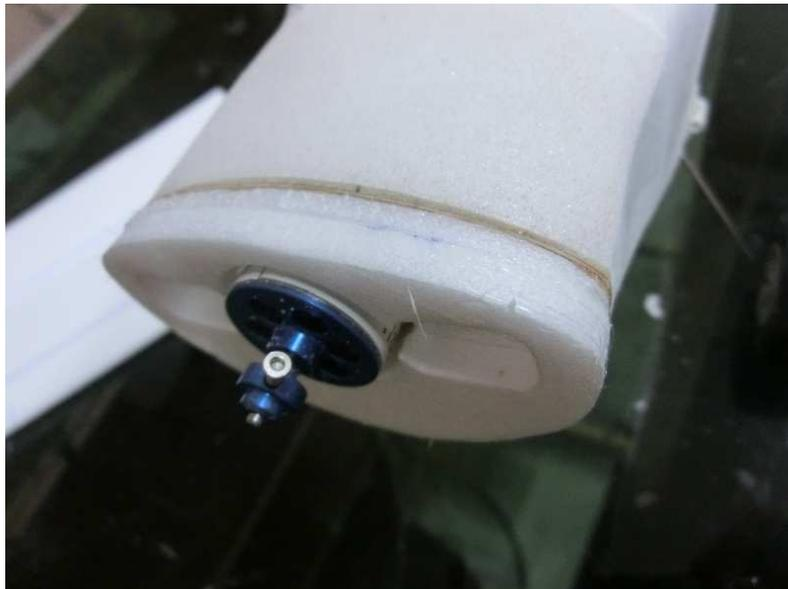
**36. Nun die Abschlusspanen 6 + 7 zusammenverkleben und anschließend auf den Sperrholzspant kleben. Darauf achten, dass der Motor frei laufen kann.**
