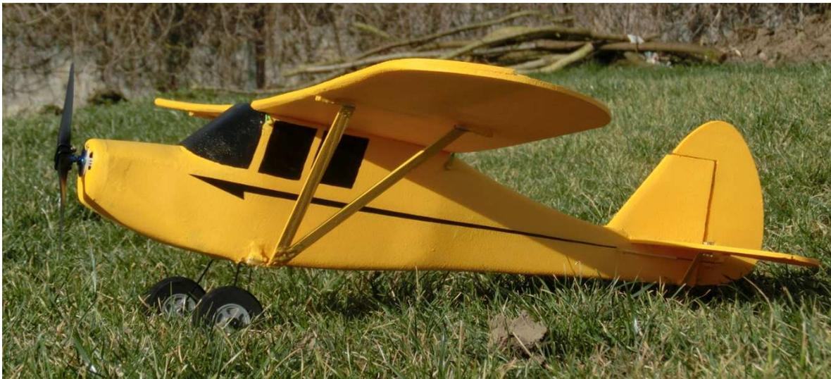
**Foto zeigt den Prototypen mit KF Tragfläche und Streben. Damit das Modell gutmütiger fliegt, wurde die Tragfläche gegen der gewölbten Version getauscht. Die Streben sind nun nicht mehr nötig, da die Tragfläche eigenstabil ist. Wer will, kann zwecks originalen Aussehen diese Streben anbringen.**
