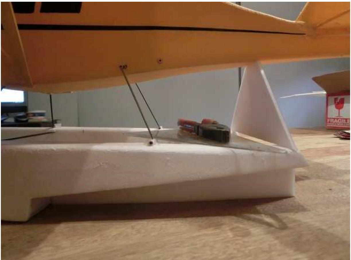
18. Da die Strebenaufnahmen auf den Schwimmern auch aus Bowdenzugröhrchen bestehen, diese ablängen und auf die Streben schieben.
