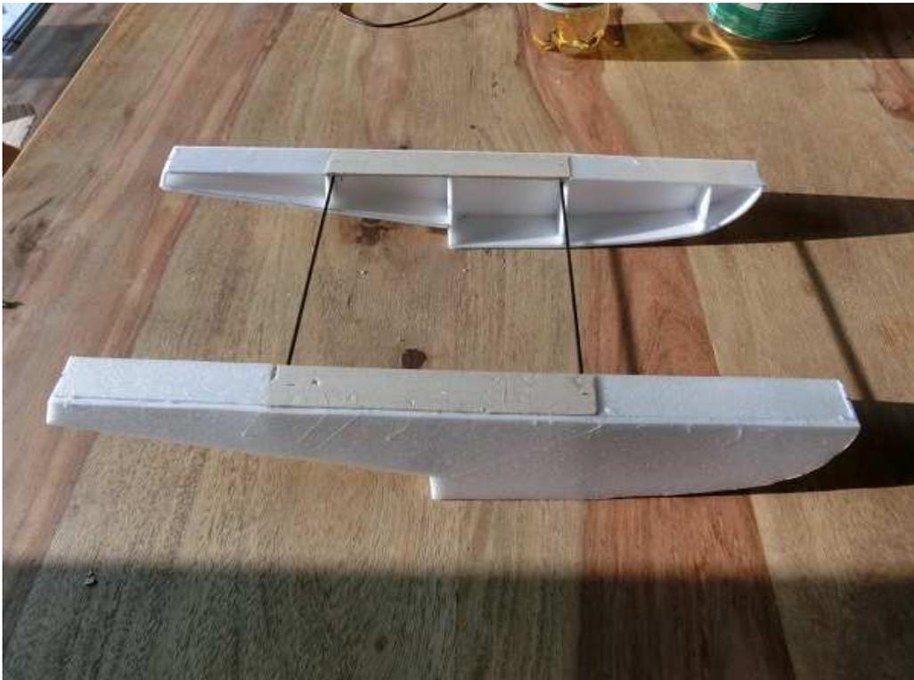
11. Die hinteren Schwimmerstreben werden nun vorbereitet. Dazu laut Zusatzblatt die beiden 1,5 mm Fahrwerksdrähte biegen.
