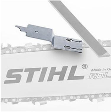
Zum manuellen Bearbeiten des Tiefenbegrenzers aus gehärtetem Stahl mit Spezialbeschichtung. Zwei Einstellungen für Hartholz und Weichholz. Mit dem Haken kann sowohl die Nut der Schiene als auch die Ölbohrung der Schiene gereinigt werden.
