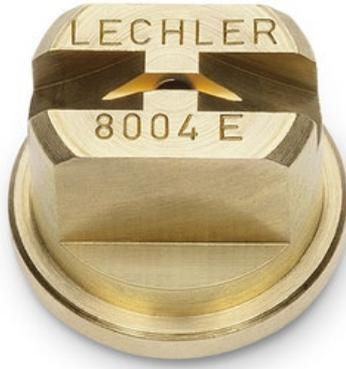
Flachstrahldüse mit großem Kaliber für Flächenanwendungen. Besonders geeignet für die grobtropfige Unkrautbekämpfung. Spritzwinkel 80°. Spritzdruck optimal 2,0 bar. Für SG 31. Zur Montage an SG 21, SG 51 und SG 71 ist ein Düsenhalter erforderlich.
