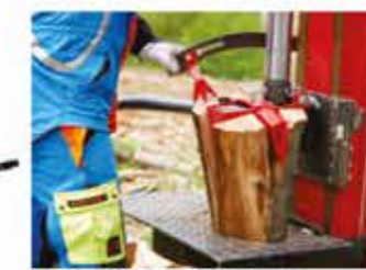
Linke Bedienungshebel mit integrierter Spaltgutfixierung und Spaltkreuz
