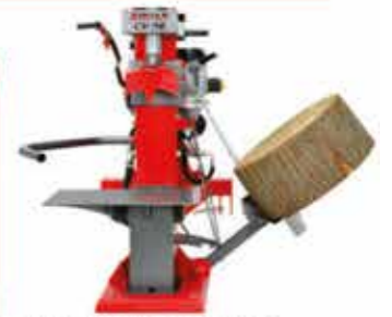
Zusätzliche Hubvorrichtung für Kurzholz
