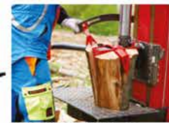
Linke Bedienungshebel mit integrierter Spaltgutfixierung und Spaltkreuz
