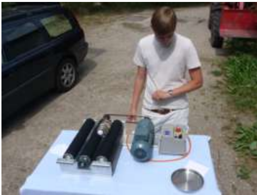
Für jeweils 1 Minute werden die Schoten mit den Golfbällen im Glas mittels Rollen gedreht
