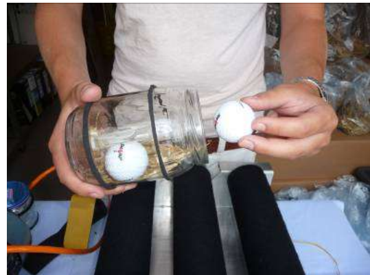
Zwei Golfbälle erhöhen die mechanische Belastung
