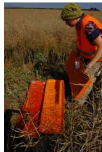
Auslegen von 3 Verlustprüfschalen
