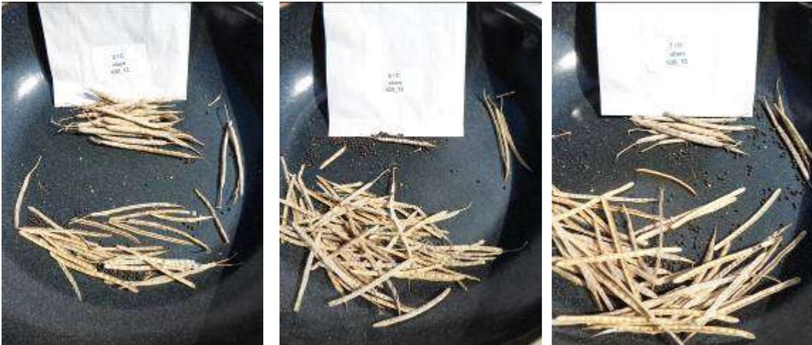
genutzt. In einem Behälter, der sich mit definierter Geschwindigkeit in definierter Zeit dreht, werden 30 Schoten einer mechanischen Belastung ausgesetzt. Anschließend wird der Behälter geöffnet und die aufgeplatzten Schoten, getrennt nach ganz bzw. halb geöffneten Schoten, gezählt.
