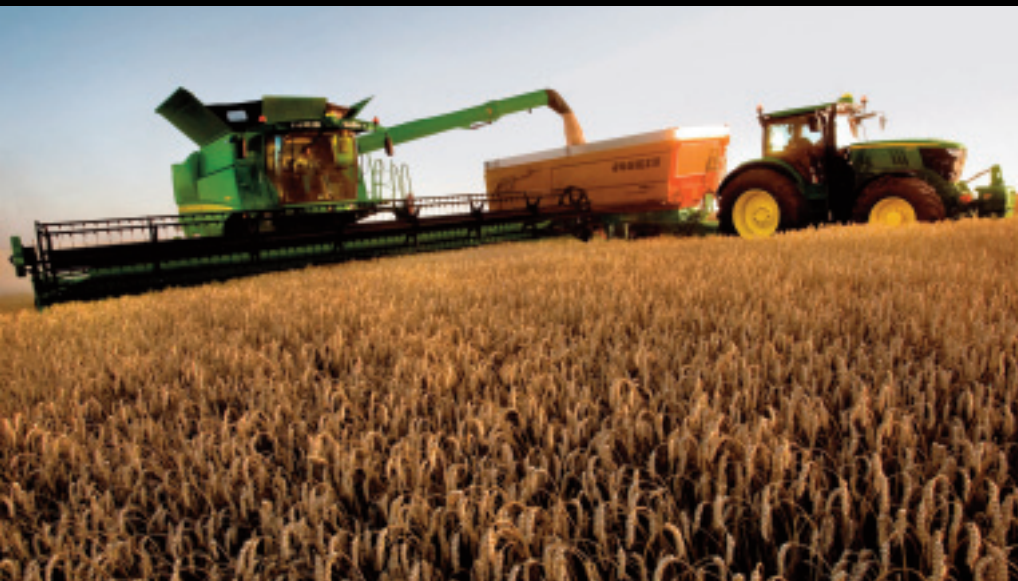
▲ „MachineSync“ von John Deere: Beim Abtanken steuert der Mähdrescher den nebenherfahrenden Traktor.
