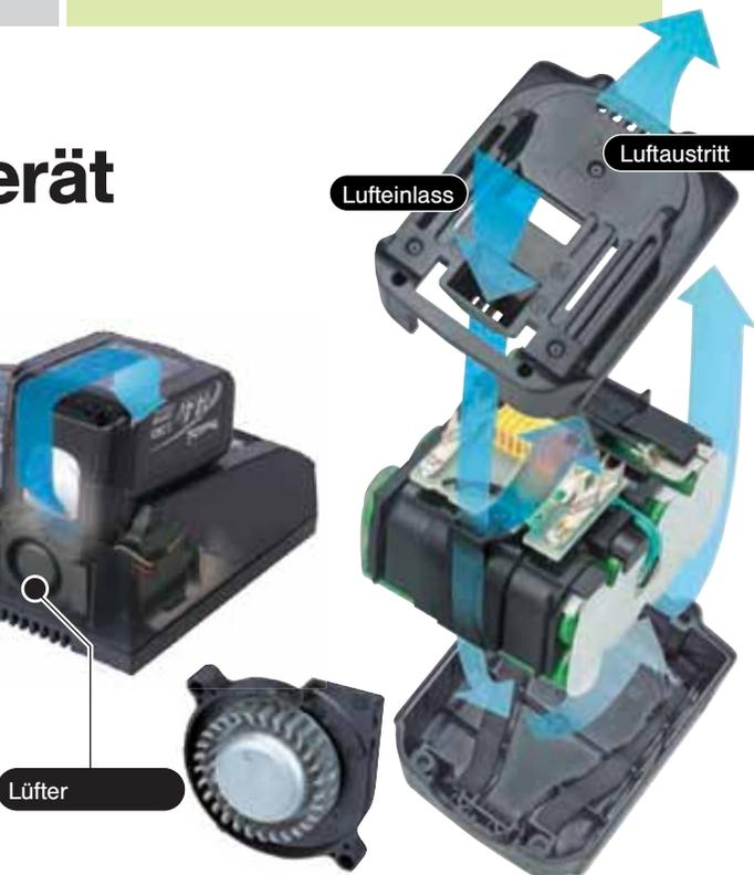
Durch ein optimal abgestimmtes System zwischen Akku und Ladegerät werden bei Makita die Akkuzellen gleichmäßig und schnell gekühlt, damit ein neuer Ladevorgang schnellstmöglich gestartet werden kann. Dazu wird der Kühlluftstrom durch spezielle Lüftungskanäle im Akku an den Zellen vorbeigeleitet und die warme Luft schnell nach außen abgeführt. Während des Ladevorgangs kann durch die Kühlung mit höherem Ladestrom gearbeitet werden und somit eine kürzere Ladezeit erreicht werden.
